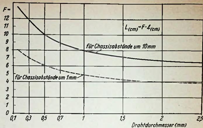
Bild 3. Kurve zur Ermittlung des Faktors für die Berechnung der Induktivität von Zuleitungsdrähten
