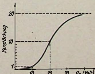
Bild 5. Verstärkung eines Transistors in Abhängigkeit von der Gleichspannung des zweiten Kreises
