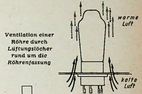
Ventilation einer Röhre durch Lüftungslöcher rund um die Röhrenfassung
