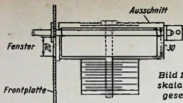
Bild 1. Trommelskala von unten gesehen, ganz unten der Drehkondensator
