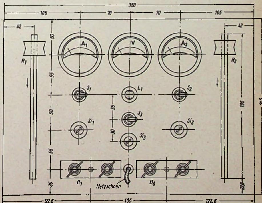
Bild 4. Maßskizze und Einzelteileanordnung an der Frontplatte
