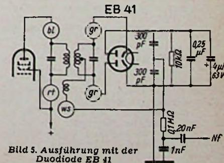
Bild 5. Ausführung mit der Duodiode EB 41
