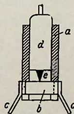
Links: Bild 1. Grundsätzlicher Aufbau einer Messertriode. a = Isolierstoffröhrchen, b = Doppel-folienband, c = Foliend-Anschlüsse, d = Haltebolzen für den Kristallgrat, e = Kristallgrat
