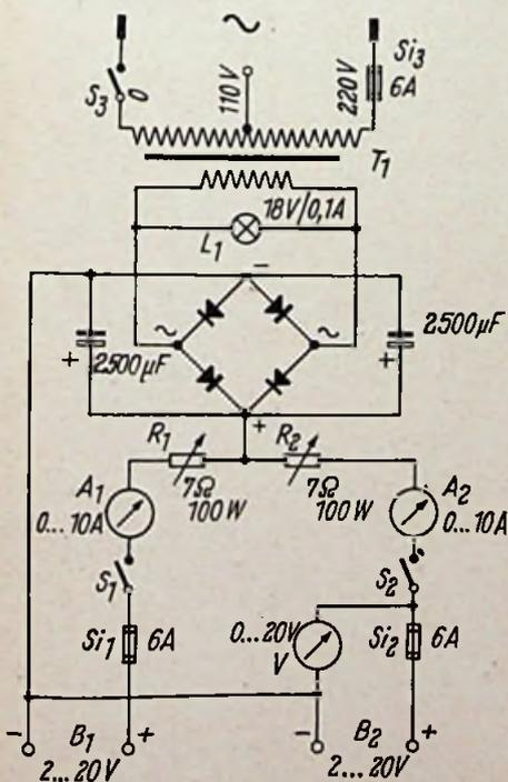
Bild 3. Schaltung des Netzgerätes für Kleinspannungen
