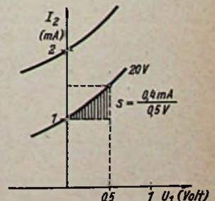
Bild 6. Änderungen des Stromes  $I_2$  in Abhängigkeit von der Spannung des ersten Kreises
